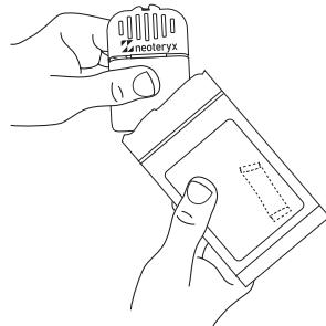
2. Abra el dispositivo separando las solapas del mismo hasta que queden dobladas hacia abajo.
