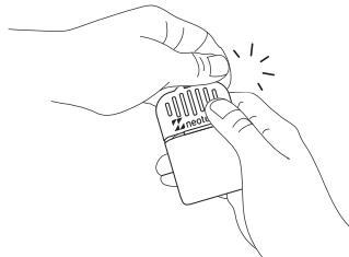
7. JEŚLI OTRZYMANO WOREK NA PRÓBKĘ: włożyć urządzenie do woreczka na próbki i szczelnie zamknąć. Upewnić się, że środek osuszający znajduje się w woreczku.
