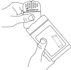
2. Öffnen Sie das Gerät, indem Sie die Laschen am Gerät auseinanderziehen, bis die beiden Klappen nach unten geöffnet sind. **HINWEIS:** Entfernen Sie die Spitzen der Probenehmer NICHT von den Körpern der Probenehmer. Entfernen Sie die Körper der Probenehmer NICHT vom Gerät.
